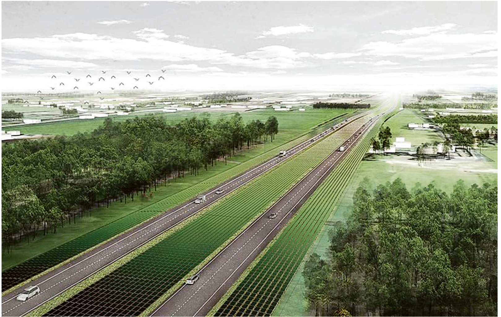
Toekomstbeeld van de A37. Het plan is om aan weerszijden van de weg en in de middenberm duizenden zonnepanelen aan te leggen. ILLUSTRATIE PROVINCIE DRENTHÉ
